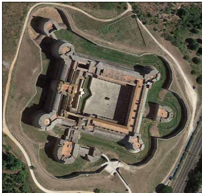
14b Salses kapuvédelmi rendszere és árka a várarók külső partjáról. Az egész erődítményt a tűzéréség elleni harcra tervezték: mélyen az árokba súlylyesztették, a védműveket viszonylag alacsonyra építették és mindenütt íves felületeket alakítottak ki
