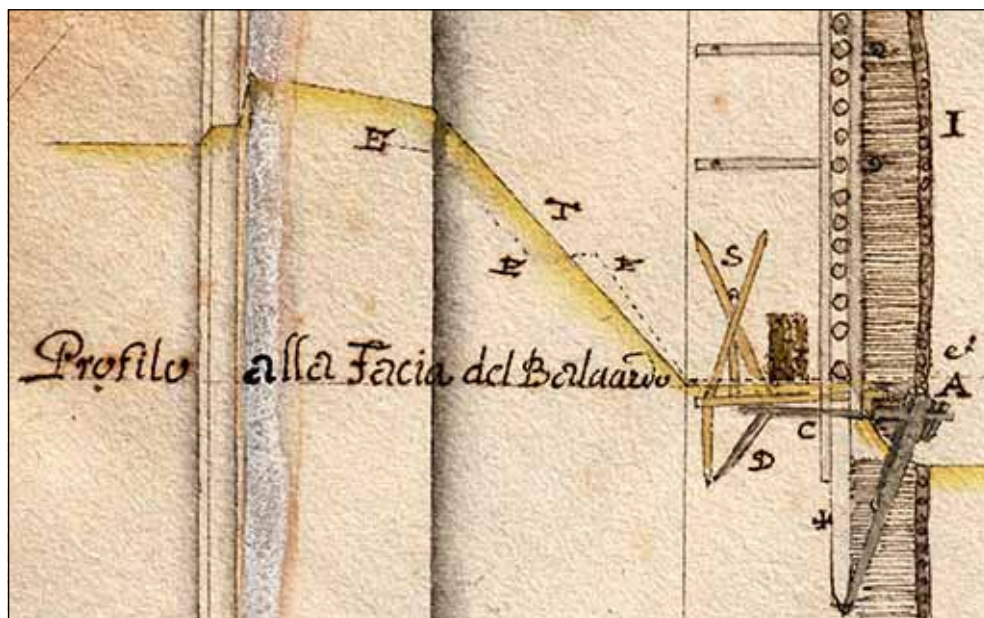
8a Giovanni Giuseppe Spalla hadmérnök keresztmetszeti rajza az egyik szatmári bástyáról és annak kidölt lábazatáról, 1671 (részlet a 8. képről)
