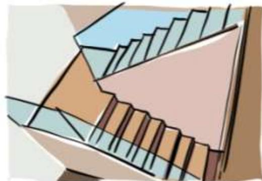
Fig. 26 Escalera de ida y vuelta ciega.
