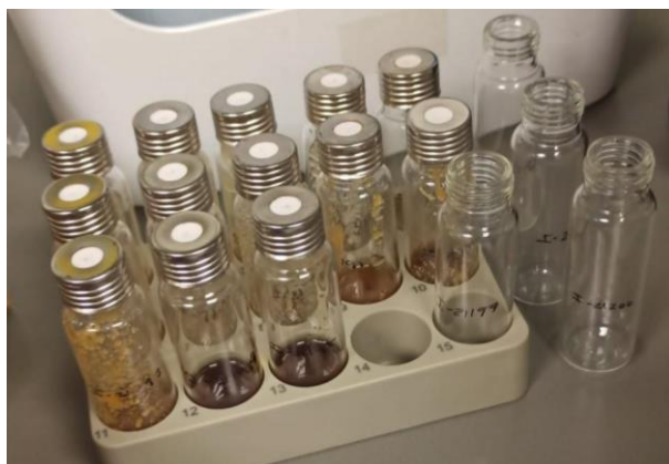
Figura 9: Muestras de miel en los viales para el análisis del perfil volátil (Fuente propia)
