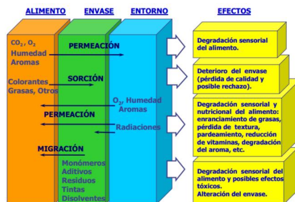
Figura 8: Esquema de la transferencia de sustancias envase - alimento (ENVASES PLÁSTICOS, 2017)
