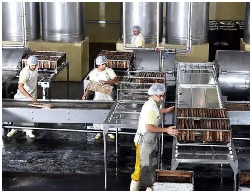
Figura 2: Procesado industrial de la miel. Desoperculación de los cuadros y extracción de la miel (LA TIENDA DEL APICULTOR S.L.U., s.f.)
