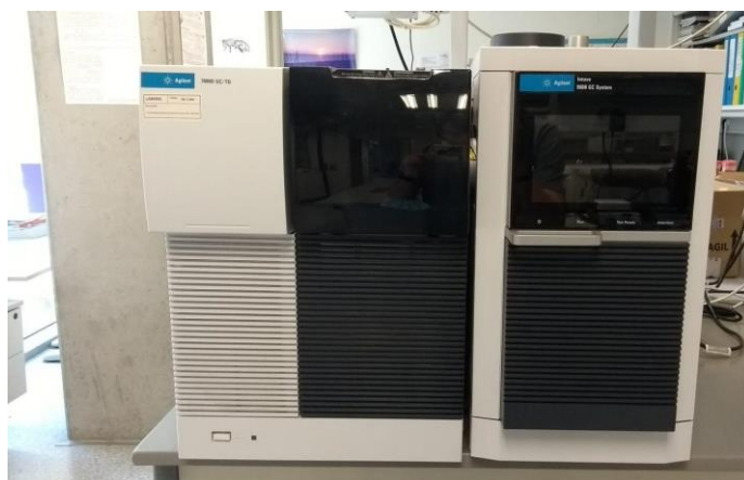
Figura 10: Equipo SPME-GC del laboratorio "LABMIEL" empleado en el análisis de las muestras de mieles (Fuente propia)
