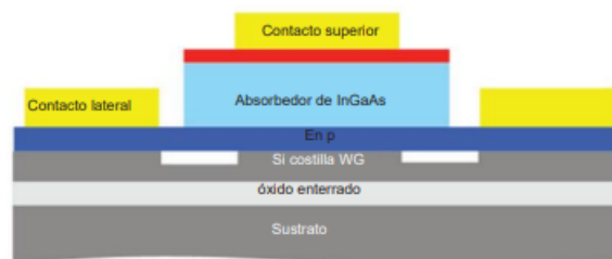
Figura 8. Corte transversal de fotodetector de guías de ondas con configuración vertical implementando tecnología InP. [2]
