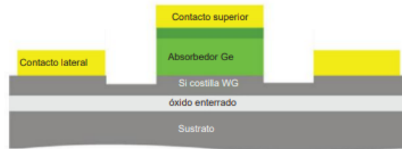
Figura 7. Corte transversal de fotodetector de guías de ondas con configuración vertical implementando tecnología SoI. [2]
