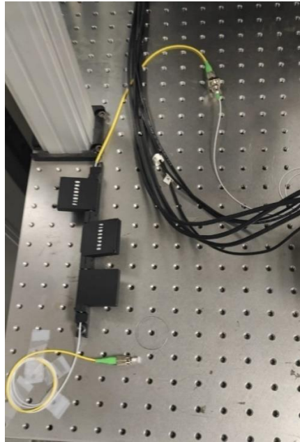
Figura 20. Entrada y salida de la fibra por los moduladores de polarización.
