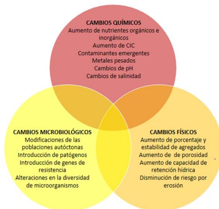
Figura 7. Cambios producidos en el suelo tras la adición de lodos. Fuente: elaboración propia.
