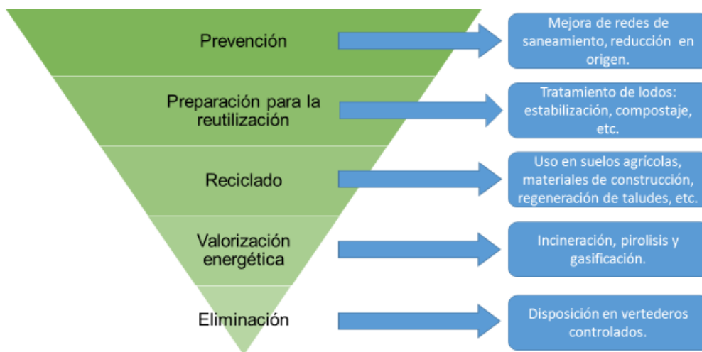
Figura 3. Principio de jerarquía en la gestión de los lodos de depuradora. Fuente: elaboración propia.
