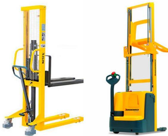
**Figura 9.** Carretilla elevadora manual (izquierda) y eléctrica (derecha)
