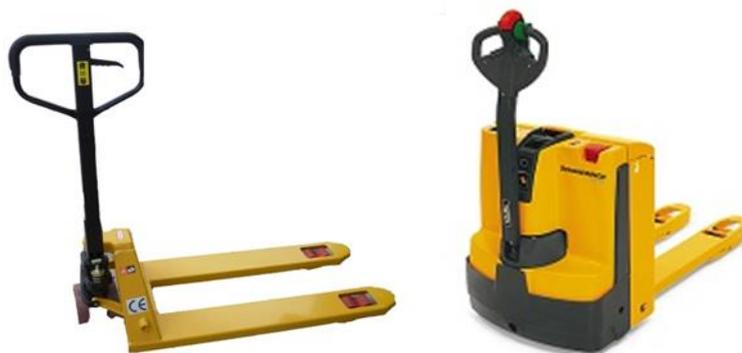
**Figura 8.** Transpalé manual (izquierda) y eléctrico (derecha)
