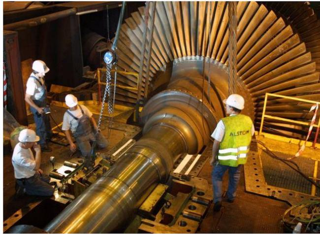
FIGURA 24. MANTENIMIENTO SOBRE UNA TURBINA
