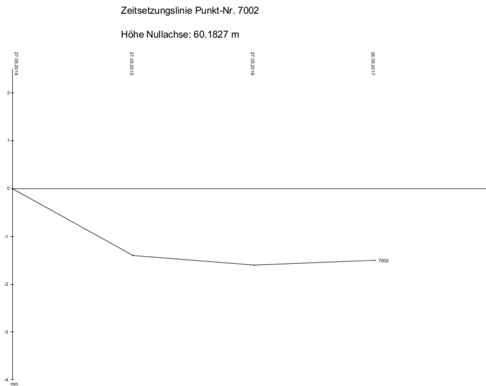
Abbildung 46: Setzungsverlauf für Punkt 7002
