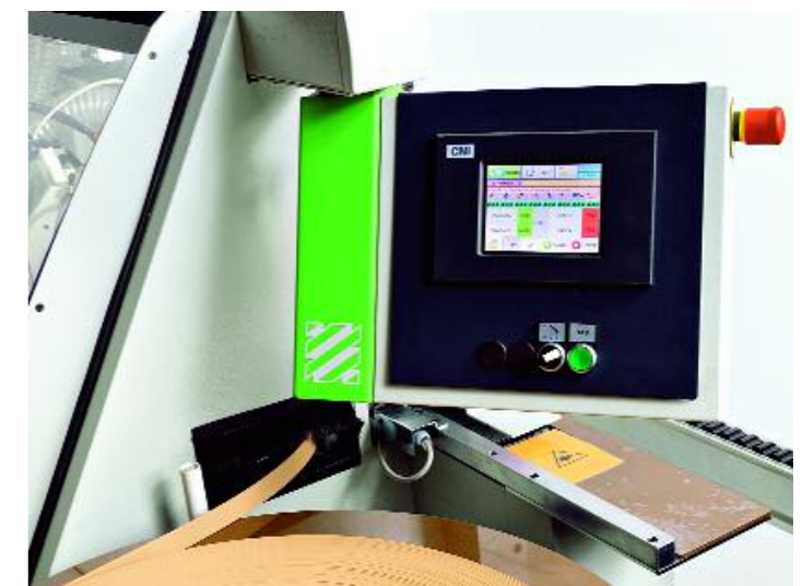
Numerische Steuerung TS06 mit Graphisches LCD 6" Farb-Display touch screen. Auf Wunsch kann auf die Steuerung TS10 mit 10 Zoll Farbbildschirm als Touch-screen erweitert werden.
