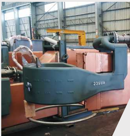
阿波达卡生产车间制造电弧炉和钢包炉的各种核心部件。照片中是Quantum电弧炉使用的电极臂。
