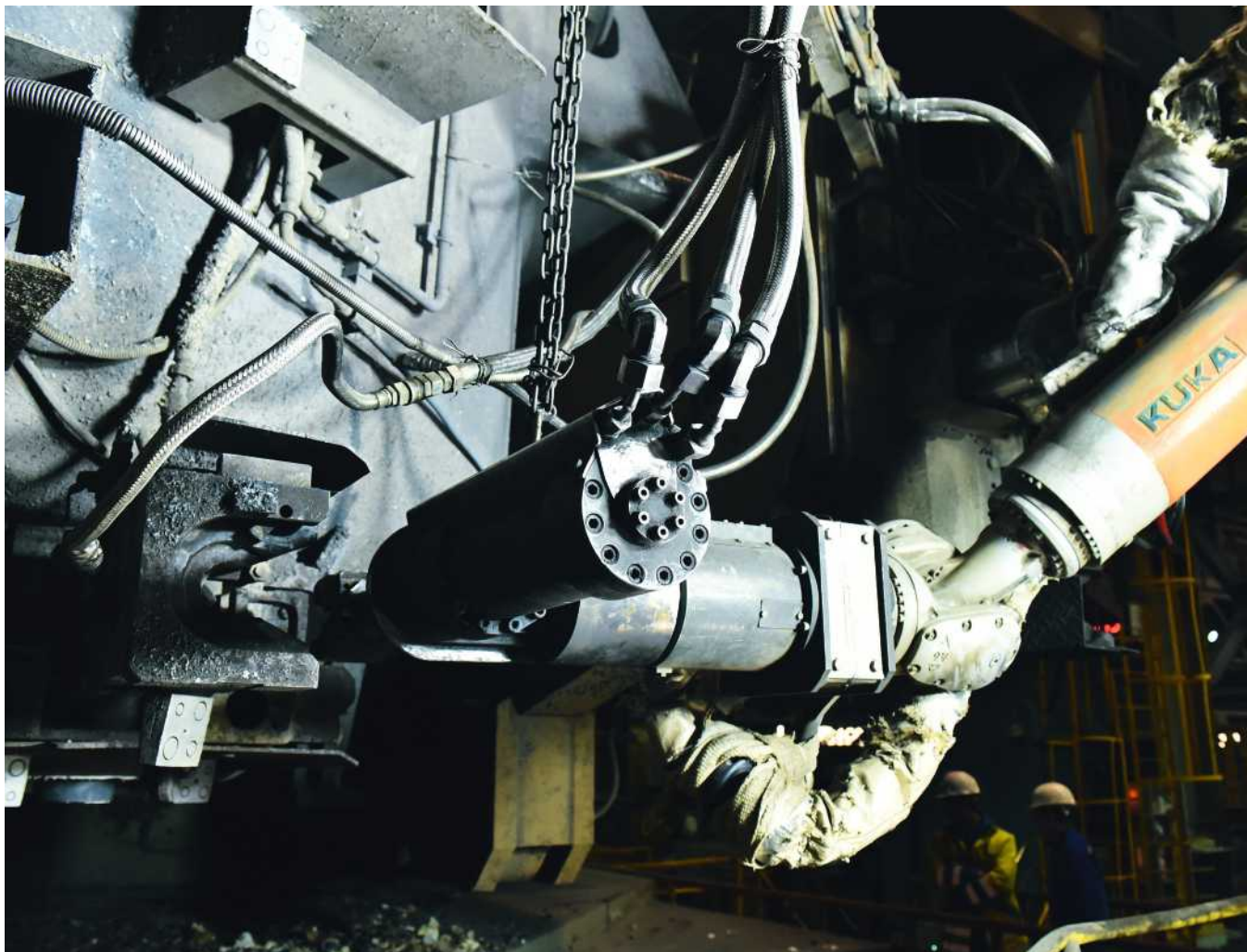
图1: LiquiRob如今能够在钢包回转台加载侧全自动完成钢包连接操作: 将滑动水口液压缸插到钢包上并接通气体接头和电信号连接器。
