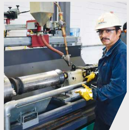
该机构承接的维修业务之一是连铸辊修复。修复后辊面厚度将增大9毫米。
