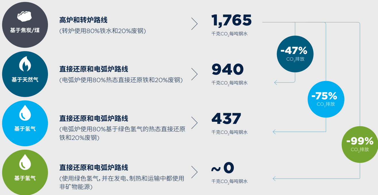
图2：不同钢水生产工艺路线二氧化碳排放量的比较。除非另有说明，计算均以经合组织欧洲成员国发电排放水平为基础。
