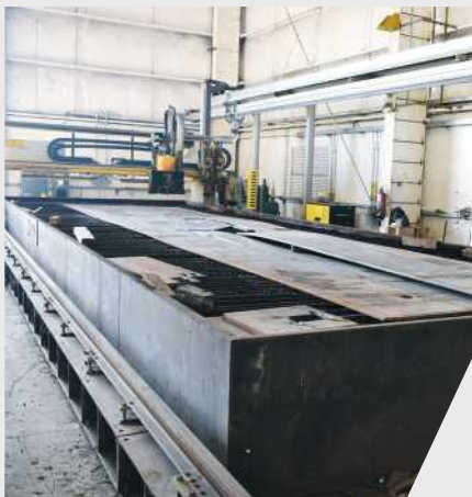
每个车间都有一台这样的板材切割机。它采用了强大的等离子技术，能够切割厚达20厘米的钢板。
