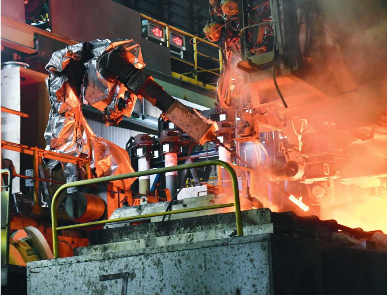
图2：同一台机器人既能执行长水口操作也能执行探头操作——借助于气动工具快换装置。
