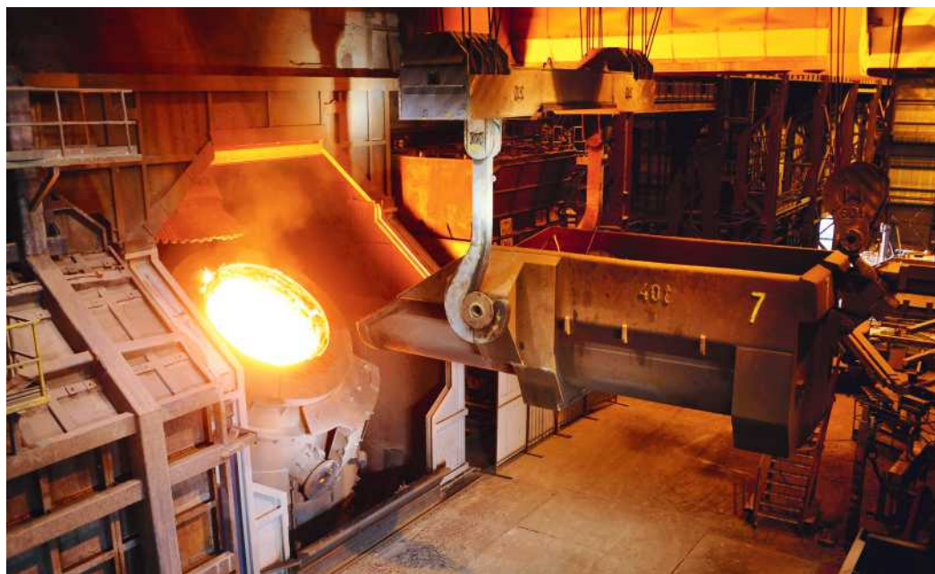
一座转炉正在装入废钢。提高废钢和HBI比例能够让炼钢变得更加环保。
