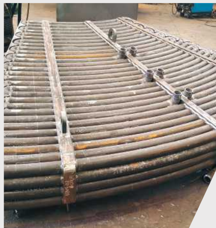
这是水冷系统的一部分，它将安装在电弧炉的炉盖上。多个这样的部件结合在一起，实现360度全覆盖。
