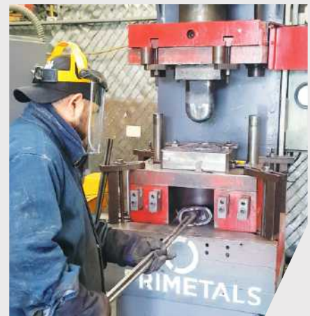
该机构购置了3台能够制造“弯头”的新设备。弯头是焊接在两个相邻管端部的部件。
