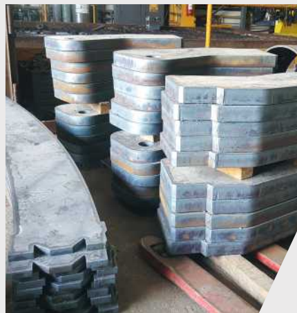
生产工人将把这些部件变成Quantum电弧炉的“手指”。手指在预热时托住和释放废钢。
