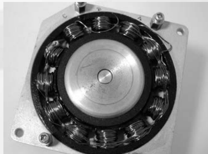
Elektromotor mit Magnetrotor auf Buchse mit Stahlachse
