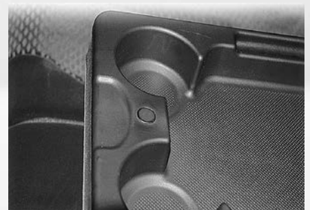
KFZ-Mittelkonsole mit INN in Kunststoffaufnahme
