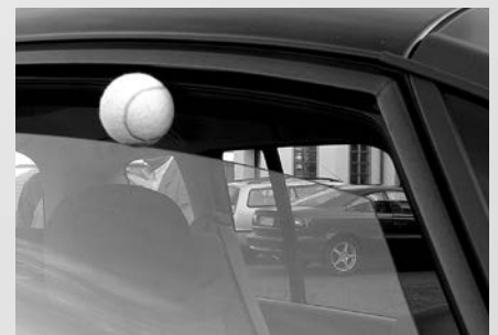
Einklemmschutz bei elektrischem Fensterheber durch Magnetrotor
