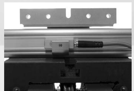
Pneumatikzylinder mit Positionskontrolle
