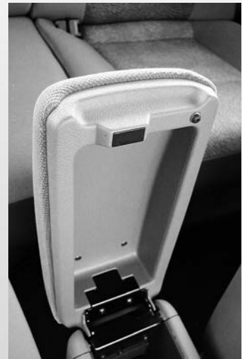
Prototyp Mittelarmkonsole mit Klip SD Type
