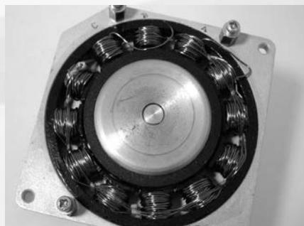
Elektromotor mit Magnetrotor auf Buchse mit Stahlachse
