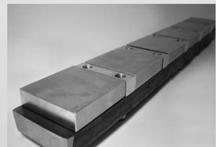
Prototyp Magnetsystem für Wirbelstrombremse
