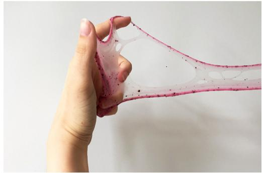
angegeben hinzugefügt wird das Material glitschig und kann nur noch sehr schlecht geknetet werden. Schwarzer Tee verstärkt die Elastizität des Materials, jedoch zerstören die Körner die glatte Oberfläche. Möglicherweise könnte das Pulver durch Konzentrat ersetzt werden, wodurch dies verhindert werden könnte.
