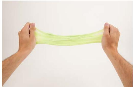
nicht mehr klebrig, jedoch entstanden durch das grobe Kneten Risse, welche nicht bearbeitet werden konnten. Das Beifügen von Speisestärke bewirkte eine noch höhere Stabilität, die Masse blieb während des Kneten weich. Risse konnten durch weiteres Kneten wieder bearbeitet werden, da Feuchtigkeit auf Druck austritt.
