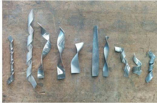
Mit dieser Technik lassen sich alle Metallarten problemlos gleichmäßig biegen. Man erhält eine Art Schraube. Wenn man den Durchmesser der Stange variiert kann man Schrauben von unterschiedlichen Durchmesser erstellen. Bei zu kleinen Durchmesser darf das zu biegende Metallstück nicht zu breit sein. Die gebogenen Stücke sind wesentlich stabiler als vorher. Selbst Aluminium lässt sich danach kaum verbiegen.
