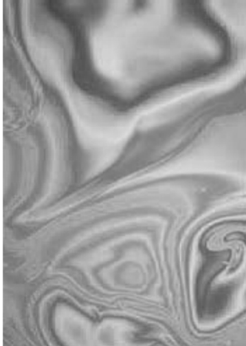
Franjas tipo arco iris en una película de aceite que flota en agua
