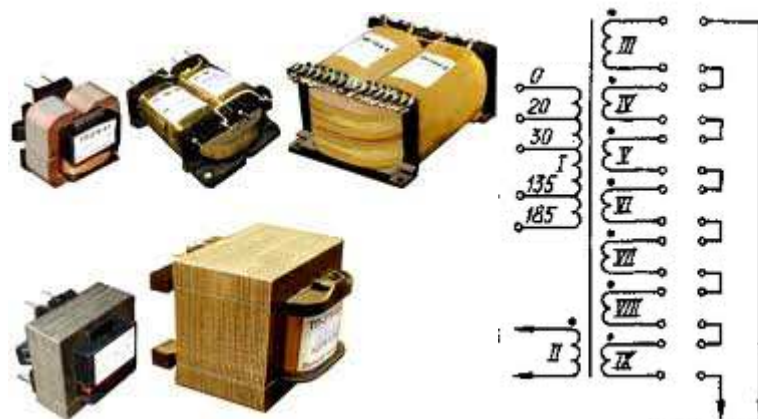
238. att. Daudztinumu transformatori
