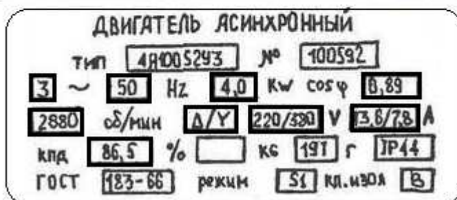
278. att. Asinhronā motora tehniskā pase (plāksnīte) 3~ fāzu skaits, 50Hz frekvence, 4,0 kW jauda, \cos\phi koeficients, 2880 apgriezienu skaits minūtē, \Delta/Y trīsstūra/zvaigznes slēgums, 220/380V spriegums atkarībā no slēguma, 3,6/7,8A strāvas stiprums.
