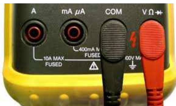
94. att. Izvadspaiļu savienošana pirms sprieguma mērīšanas
