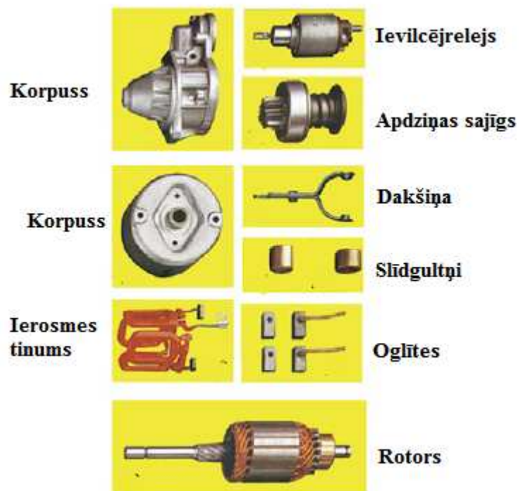
333. att. Vispārēja startera uzbūve
