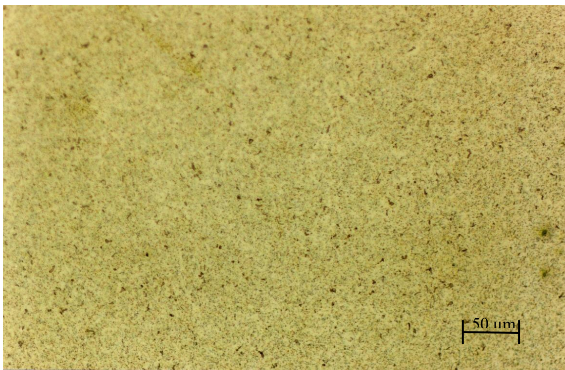
Figura 7 – Micrografia da liga no estado original. Reagente: Keller. Aumento: 200x
