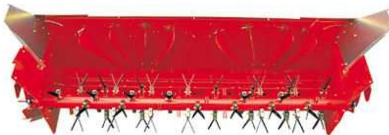
En algunos modelos de estas segadoras delante del mecanismo de corte se ubica un molinete de barra cuyo objetivo es afirmar las plantas para facilitar el corte y dirigir el material hacia los rodillos acondicionadores.
