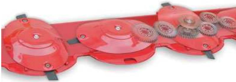
La barra descansa sobre el suelo en dos patines que regulan la altura de corte. El movimiento es transmitido a las cuchillas por un complicado juego de piñones que se ubican en el interior de la barra.
