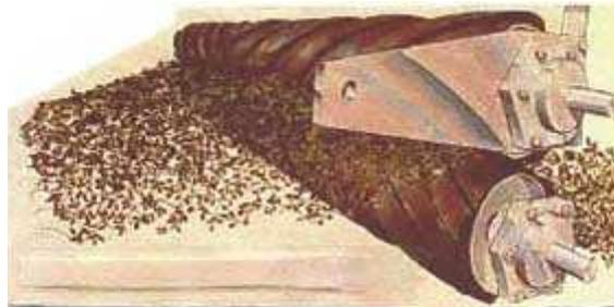
Los rodillos pueden ser de goma o metálicos o combinación de ambos con diferentes diseños de su perfil y su diámetro.
