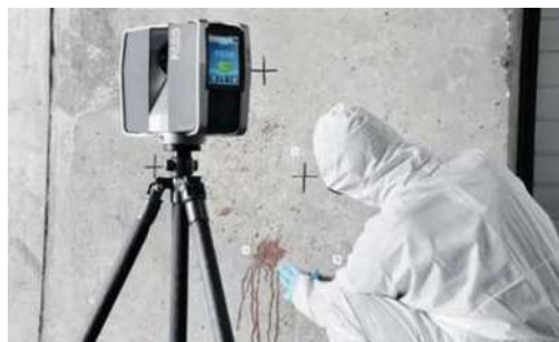
Fig. 2.3.4. Măsurarea urmei cu aparat laser
