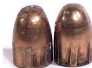
Fig. 5.3.2. Urme create de ghinturi pe glonț
