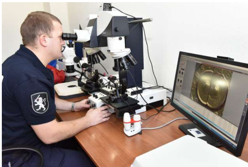
Fig. 5.1.6. Expertiza urmelor de pe muniții cu microscopul comparator
