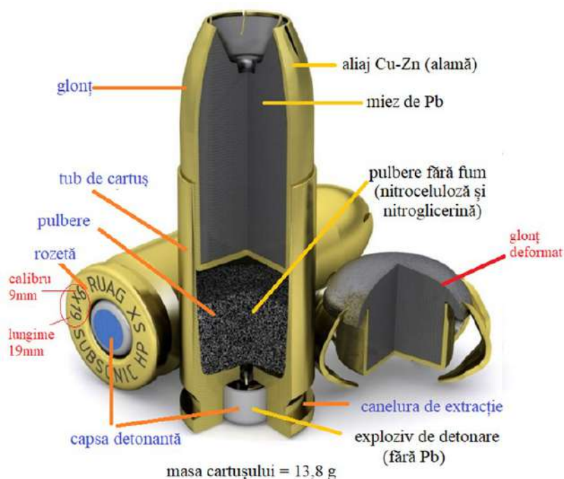
Fig. 5.2.5 Anatomia cartușului unui pistol
