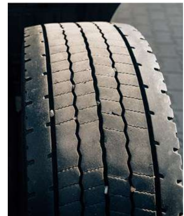
Fig. 4.1.4 Caracteristici individuale ale pneurilor formate prin uzură
