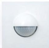
Erfasst in einem begrenzbaren Bereich (max. horizontaler Erfassungswinkel: 180°) Infrarotstrahlung, wie sie von Menschen ausgeht und schaltet z. B. das Licht an. Das System enthält einen hochempfindlichen Infrarot-Detektor. Der horizontale Erkennungsbereich und die Erfassungsweite sind veränderbar. 99 x 99 x 25 mm (B x H x T).
