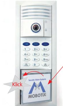
Modul immer so montieren, dass die Leiste mit **MOBOTIX** Schriftzug oben ist
