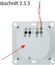
**Die beiden Anschlüsse 3 und 4 werden nur bei Nutzung einer externen Spannungsquelle (48-57 V DC) verwendet!**
