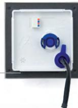
2. **Entfernen** Sie das **vormontierte Patchkabel** des Kameramoduls und stecken Sie dafür das mitgelieferte, **längere Patchkabel** ins Kameragehäuse. Bringen Sie den blauen Gummidichtring in seine korrekte Endposition.
