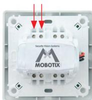
Alle verwendeten Leitungen abmanteln und ca. 5 mm abisolieren
