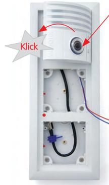
**Kontroll-Klick:** Wenn kein Klickgeräusch zu hören ist, ist das Modul nicht richtig eingerastet. Überprüfen Sie in diesem Fall die letzten Arbeitsschritte und achten Sie darauf, dass kein Kabel oder Fremdkörper im Gehäuse die Montage behindert.
