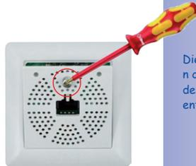
Die Schraube muss nicht komplett aus der Frontblende entfernt werden
