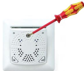
9. **Gehäuse mit Platine in Dose einsetzen:** Die beiden Kabelklemmen an der Rückseite des Gehäuses befinden sich oben. Verwenden Sie bei der Hohlraumdose nur die mitgelieferten Edelstahlschrauben. Andere (größere) Schrauben könnten die Platine beschädigen.
