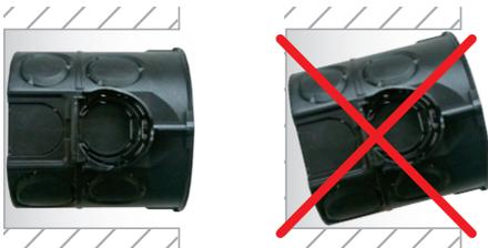
**Tipp:** Verwenden Sie einen Hohlraumdosensfräser mit Randversenker
