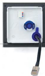
2. Verbinden Sie die mitgelieferte **MxBus-Leitung mit der Steckklemme an der Kamerarückwand**. Die Kabelenden ca. 5 mm abisolieren und dann einfach in die Klemme stecken.
