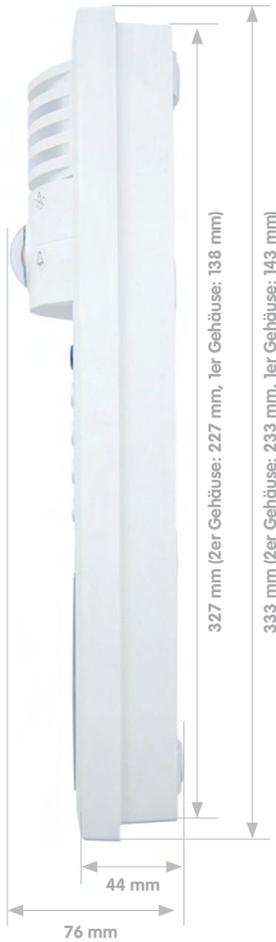
**Unterputz- und Hohlraumgehäuse (Abb. 3er Gehäuse)**
