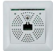
7. **Blende festschrauben:** Die Frontblende mit der dazugehörigen Edelstahlschraube befestigen.
