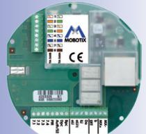
Alternativ kann die erweiterte IO-Anschlussplatine T24-OPT-IO zum Anschluss externer Geräte (Klingel etc.) verwendet werden
