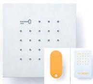
Berührungsloses Zugangs-Kontrollsystem mit Funktions-LED. Als Leseinheit von (maximal 9) elektronischen Schlüsseln (EK 601-0) oder Key-Karten (EKC 601-0) zum Öffnen von Türen, Toren etc. Schlüssel/Karte benötigt keine Batterie. 99 x 99 mm (B x H).
