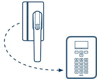
Doppelte Sicherheit durch mechanische Sicherung in Verbindung mit elektronischer Überwachung. Selbst im Falle eines deaktivierten Zustands der Zentrale bietet die einzigartige ABUS Mechatronik besten Schutz.
