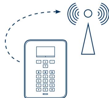
Durch die geringe Sendeleistung von maximal 10 Milliwatt beläuft sich die Funkemission der Secvest auf nur 0,5 % der Leistung von Mobiltelefonen und erlaubt so den bedenkenlosen Einsatz zu Hause oder im Betrieb.
