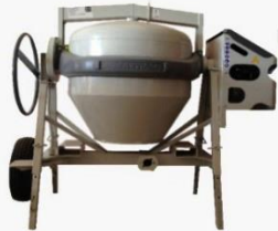
Une bétonnière 165 litres ou 300 litres
