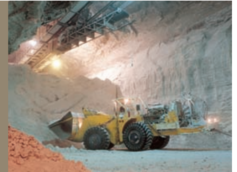
oben Voraussetzung für den Voll-Konti-Betrieb waren unterirdische Großbunker, wie hier in der Grube des Kaliwerkes Hattorf (1976).
