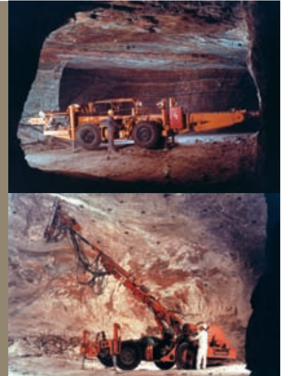
Ein Großlochbohrwagen (oben) und ein Firstankerbohrwagen (unten) in einem Bergwerk des Kalikombinats der DDR
