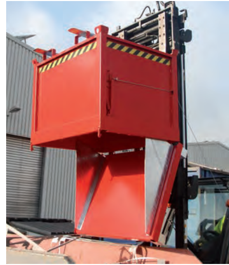
Klappbodenbehälter mit optionalen Zentrierwänden.
