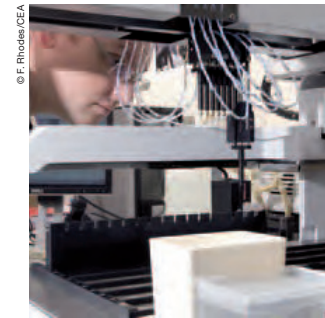
Mise en plaque robotisée d'échantillons ADN en vue du génotypage.
