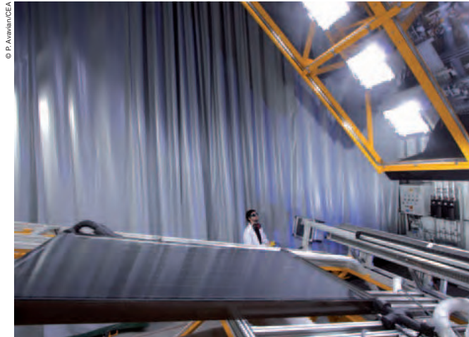
Banc d'ensevelissement pour tester la performance des capteurs solaires thermiques.
