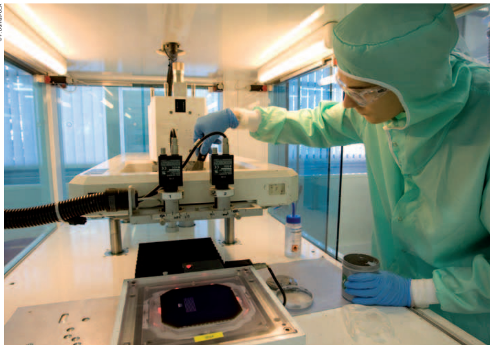
Sérigraphie d'une cellule photovoltaïque sur la plate-forme Restaura.
