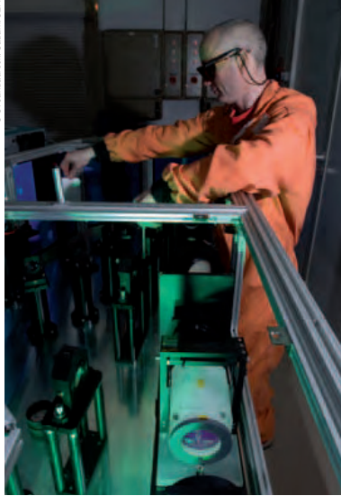
Laser Yag utilisé pour mesurer la vitesse à l'intérieur de la matière.
