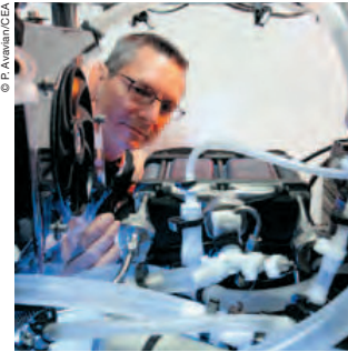
Groupe électrogène Epicea mobile et autonome pour pile à combustible.
