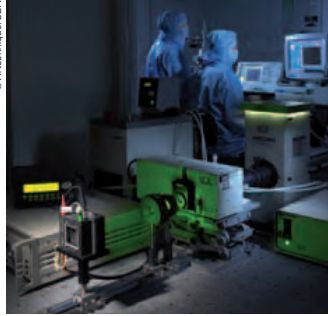
De g. à dr. : cellule de photoélectrolyse utilisée pour les études sur la production d'hydrogène par photoélectrolyse de l'eau – programme Barracuda.
