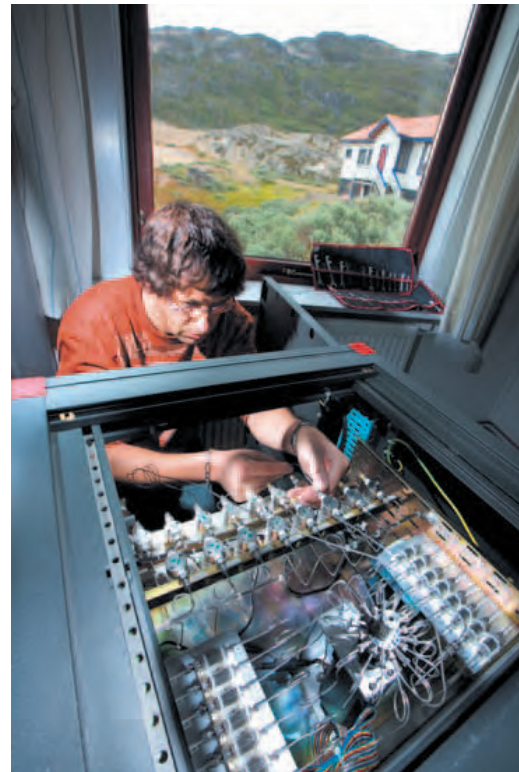
Connexion des dernières lignes (air et standard de calibration) sur l'instrument de mesure en continu du CO 2 .
