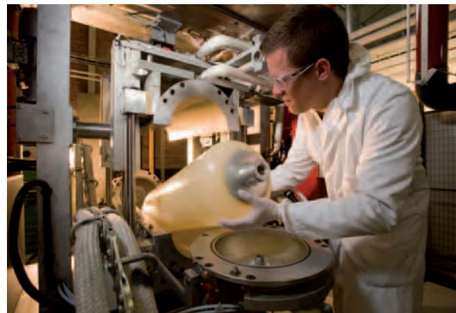
Test sur un réservoir d'hydrogène.
