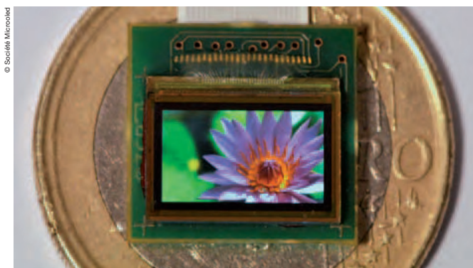
Microafficheur à base de diodes électroluminescentes (1,7 million de points élémentaires).
