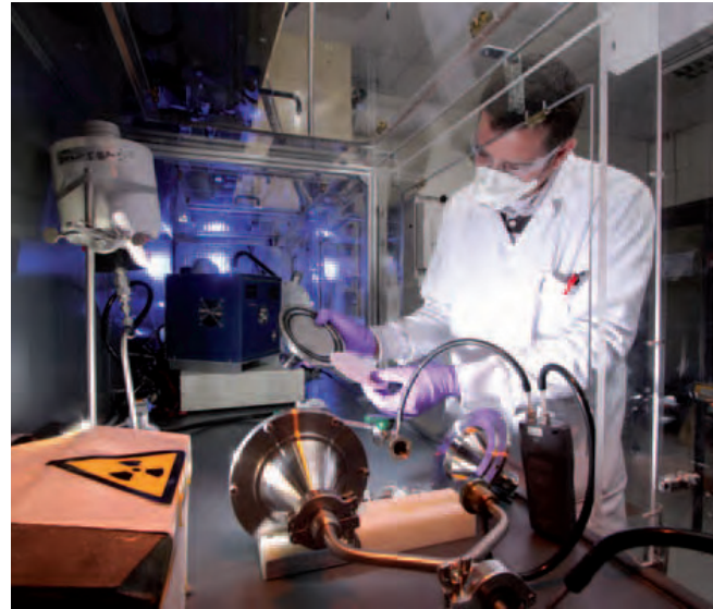
Boîte à gants dédiée aux études de nanosécurité – projet Nanosafe2.
