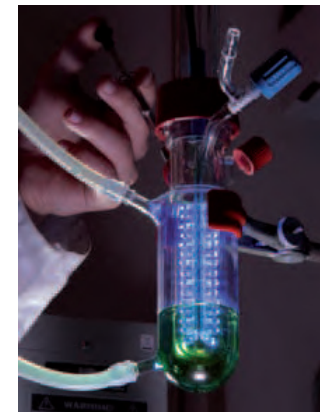
Production d'hydrogène sous irradiation lumineuse par un photocatalyseur inorganique.
