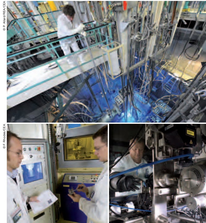
De g. à dr. : manutention en piscine du réacteur Osiris – préparation d'un programme de mesures dimensionnelles sur des combustibles irradiés – boîte à gants de soudage laser de gaines contenant les pastilles.
