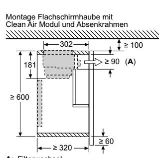
Montage Flachschriftmaube mit Clean Air Modul und Absenkrahmen
