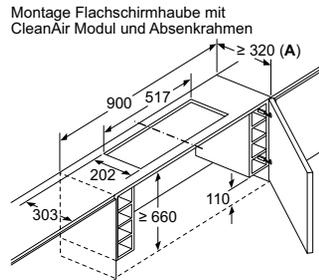
Montage Flachschriftmaube mit CleanAir Modul und Absenkrahmen
