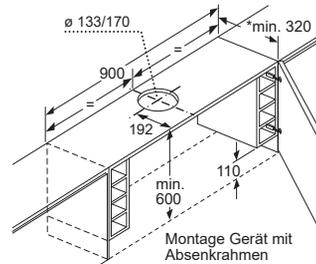
Montage Gerät mit Absenkrahmen
