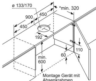
Montage Gerät mit Absenkrahmen
