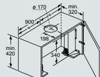
Bei Montage der 90cm Flachschirmhaube in einen 90cm breiten Oberschrank ist ein Montage-Set erforderlich. Die beiden Montagewinkel werden rechts und links im Möbel verschraubt. Montage nach Schablone.
