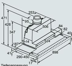
Tiefenanpassung des Filterauszuges bis 29 mm möglich
