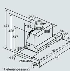
Tiefenanpassung des Filterauszuges bis 29 mm möglich
