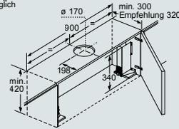
Bei Montage der 90 cm Flachschirmhaube in einen 90 cm breiten Oberschrank ist ein Montage-Set erforderlich. Die beiden Montagewinkel werden links und rechts im Möbel verschraubt. Montage nach Schablone.
