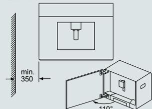
Bei Verwendung der 92° Scharnierbegrenzung (Ersatzteilnr. 00636455) beträgt der Mindestabstand zur Wand nur 100 mm.
