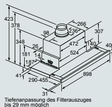
Tiefenanpassung des Filterauszuges bis 29 mm möglich
