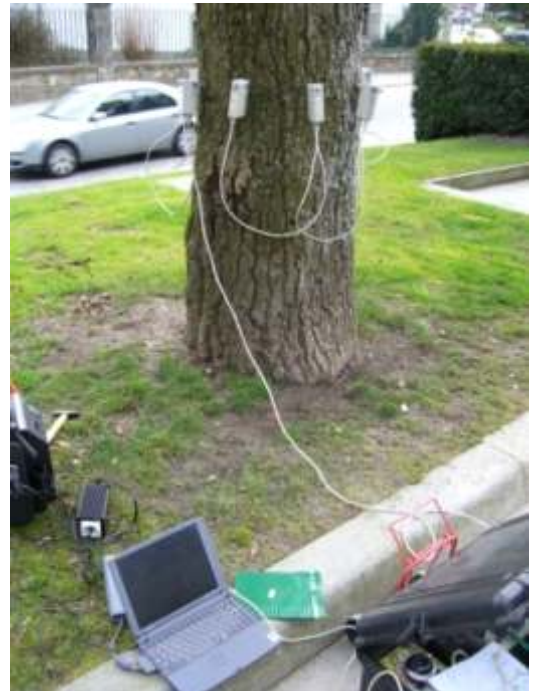
Tomógrafo de impulsos (Arbotom)
