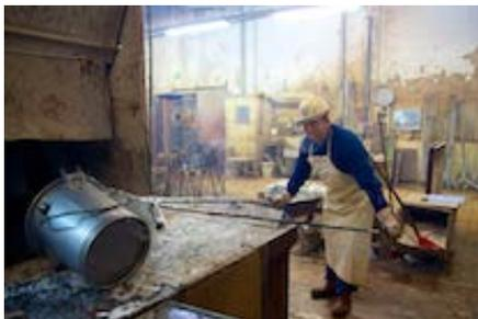
Zuerst werden die Blechteile durch ein Säurebad in das darunter liegende Zink getaucht
