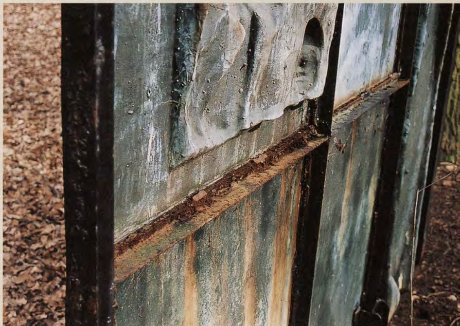
Roestvorming op brons door ijzeren structuur
