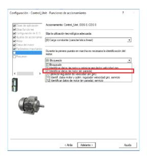
1. Al crear un nuevo proyecto se puede configurar el motor para realizar un primer ensayo de identificación de los parámetros en parada. Para llevar a cabo dicho se ensayo, se realiza un primer arranque y se observan los resultados en → lista de experto → parámetros del motor → parámetros desde el PO350 al PO360.
