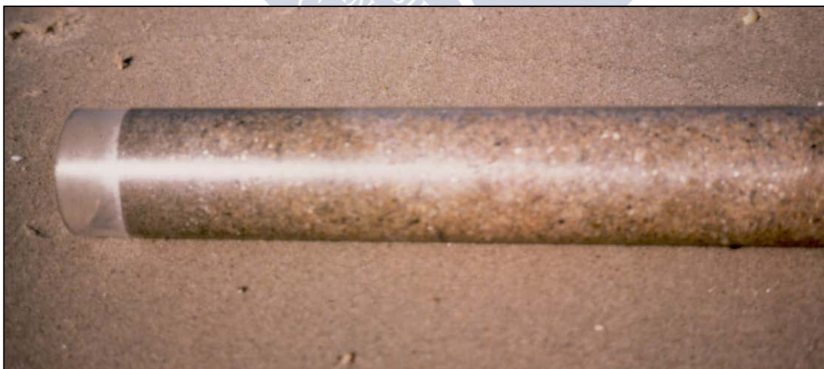
FIGURA 16. - Cilindro empleado para la recogida de las muestras estratificadas.
