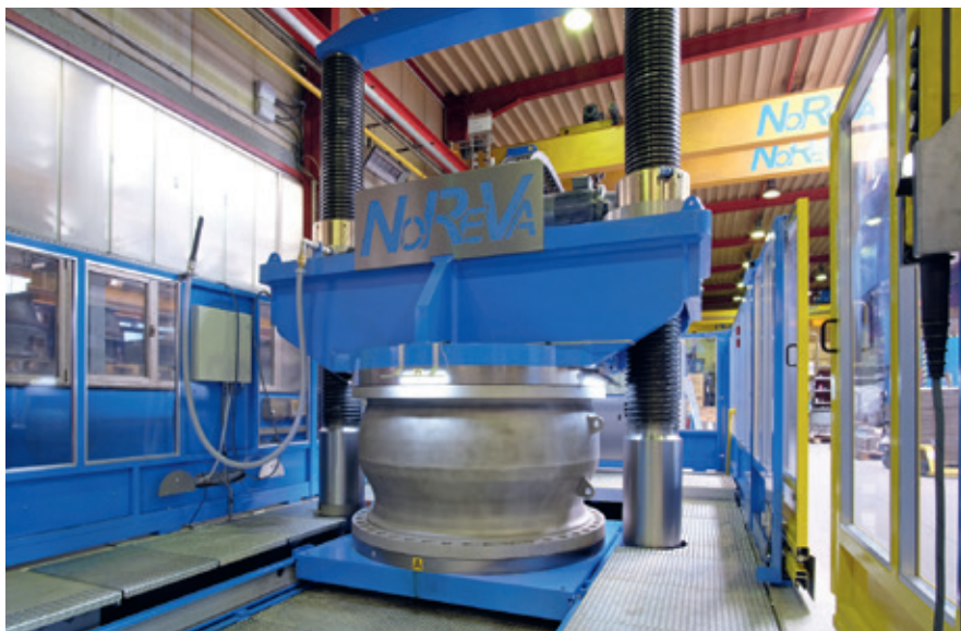
Eine der weltweit größten Armaturentestpressen ist bei Noreva im Einsatz.
