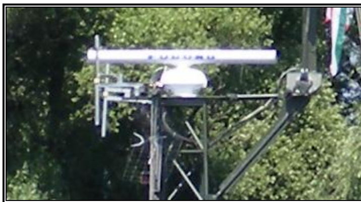
2. ábra: FURUNO antenna kereső és vevő egység az AM-31 Dunaújváros árbocán 3
