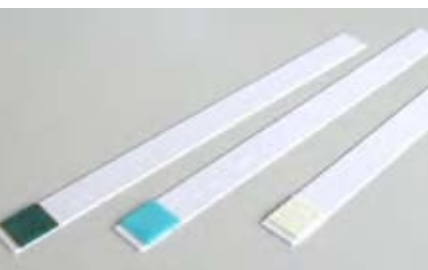
Abbildung 60: Glucosetest links: sehr hoher Gehalt außerhalb des Messbereichs, rechts: keine Farbreaktion
