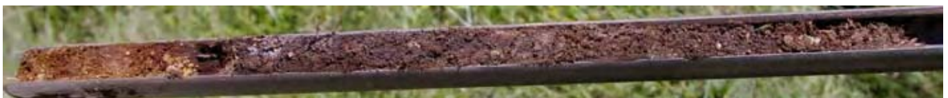
Abbildung 14 : Bohrstock mit gestörtem Bodenprofil, links der helle C-Horizont
