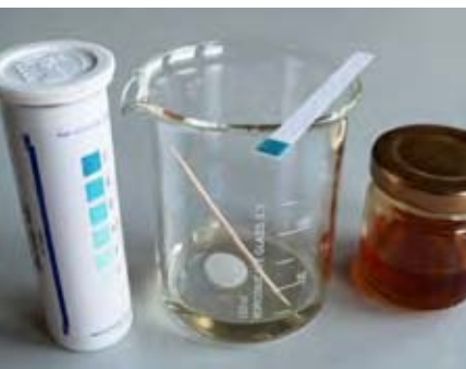
Abbildung 59: Mit Glucoseteststäbchen lässt sich der Glucosegehalt bestimmen.
