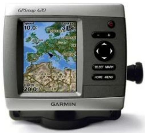
Figura 5.4-94: Dispositivo Garmin 420s utilizado para la adquisición de datos batimétricos.
