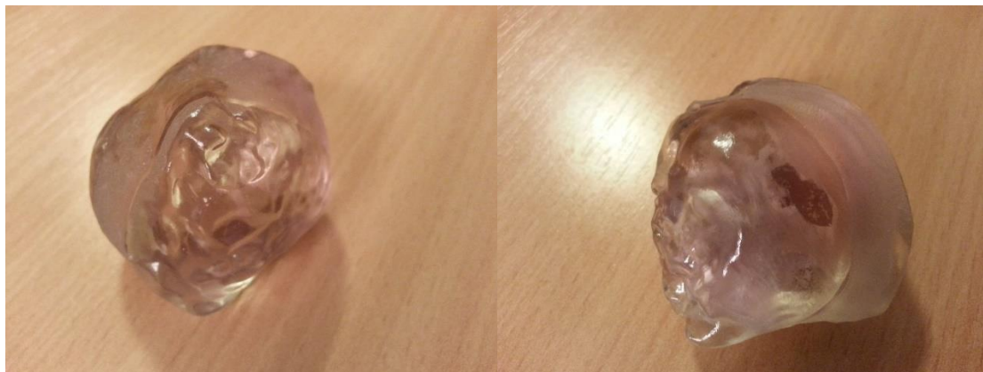
56. ábra 3D nyomtatással készített HRTF modellek
