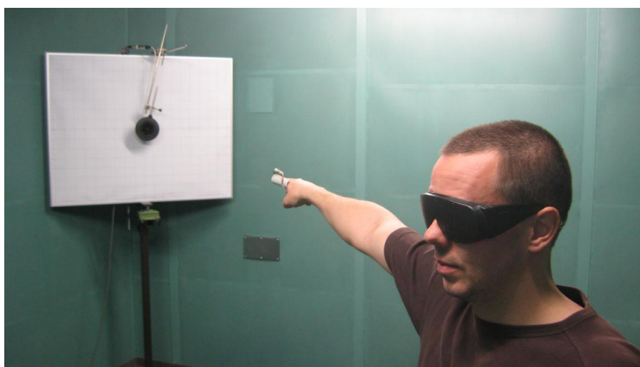
34. ábra Hangforrás irányának meghatározása a mutatóujjra erősített lézer pointer segítségével. Az eltérések a hangforrás körüli koordináta rendszerről olvashatóak le. Készítette: Répás József 2012
