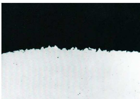
Obr. 1 Povrch navařeného vzorku (100 x Zvětšeno)
