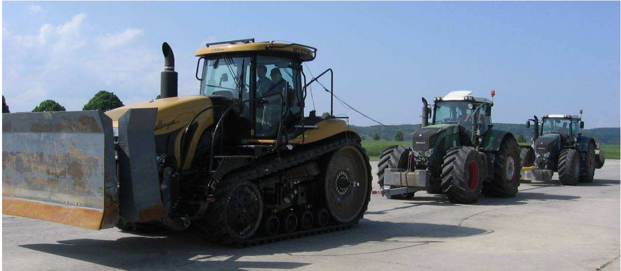
Obr. 3 - Brzdící souprava složená z měřeného traktoru a dvou brzdících traktorů Fendt 936 Vario
