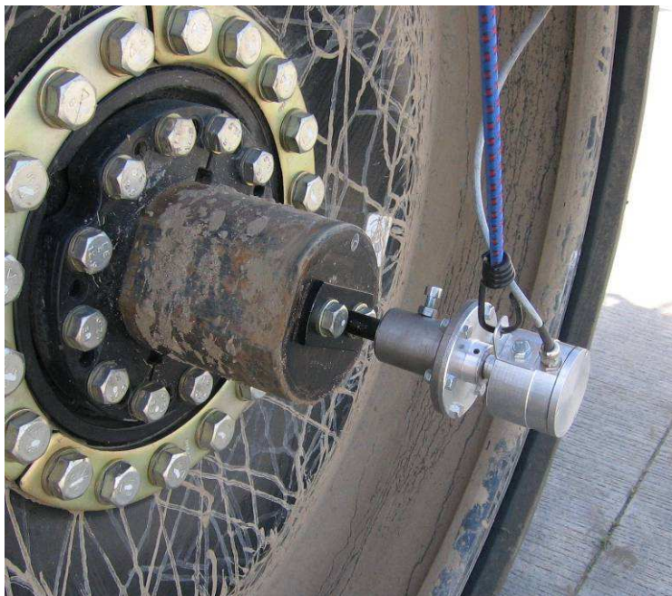
Obr. 7 – Inkrementální optický snímač otáček kola LARM
