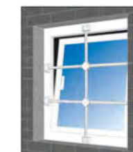
Montage auf dem Fensterrahmen
