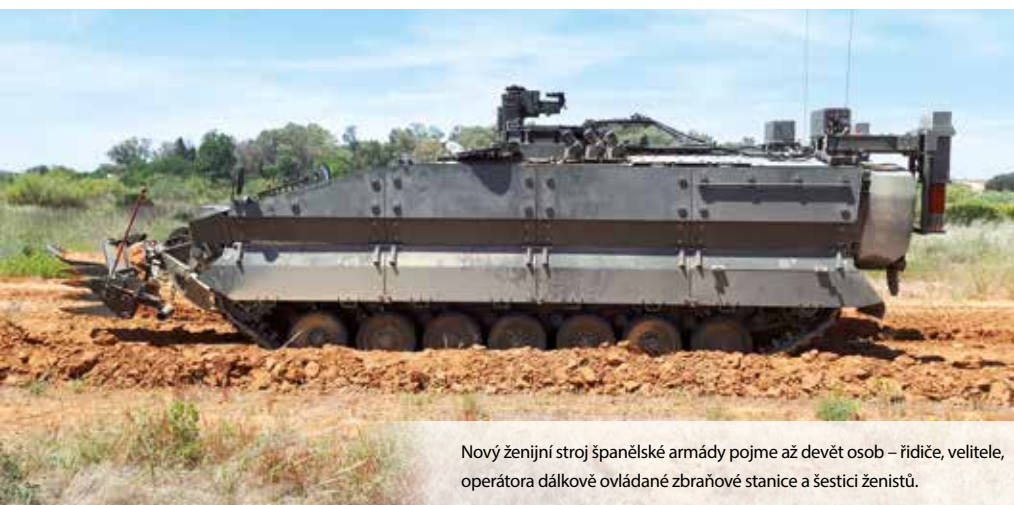
VCZAP Castor během zkoušek. Na tomto snímku je dobře patrné uchycení dozerové radlice EAB pomocí univerzálního adaptéru CIT od společnosti Pearson Engineering.
