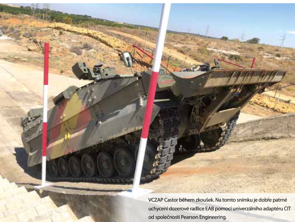
Ke stabilizaci vozidla při použití navijáku, pro přemísťování zeminy nebo k prorážení nevybušných zátarasů je možné VCZAP Castor osadit dozerovou radlicí EAB.
