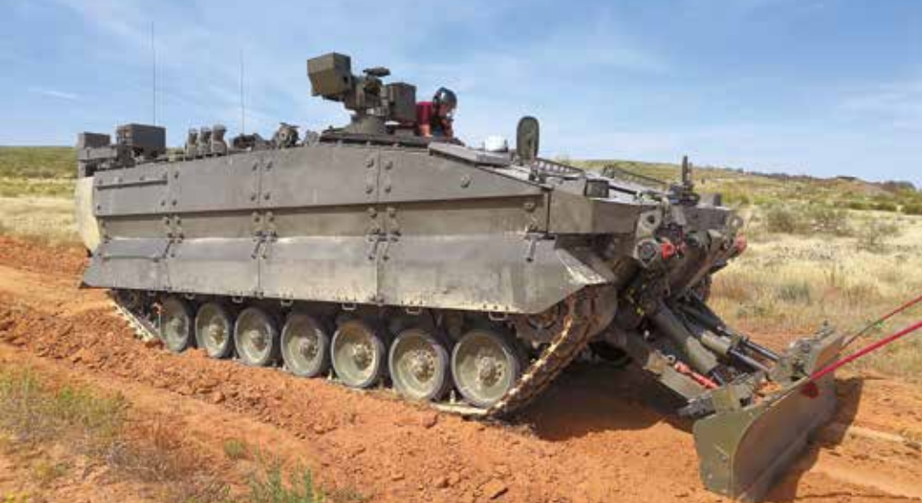
Ke stabilizaci vozidla při použití navijáku, pro přemísťování zeminy nebo k prorážení nevybušných zátarasů je možné VCZAP Castor osadit dozerovou radlicí EAB.
