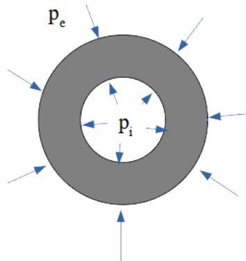
FIGURE 3 – coupe de la sphère : pression  $p_i$  sur  $S_a$  et pression  $p_e$  sur  $S_b$
