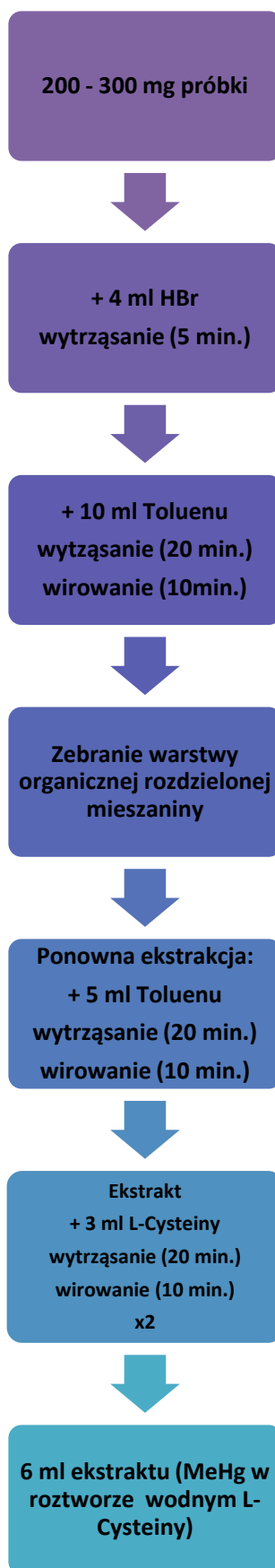
Rysunek 8: Schemat procedury analitycznej oznaczania metylortęci w próbkach biologicznych [78].
