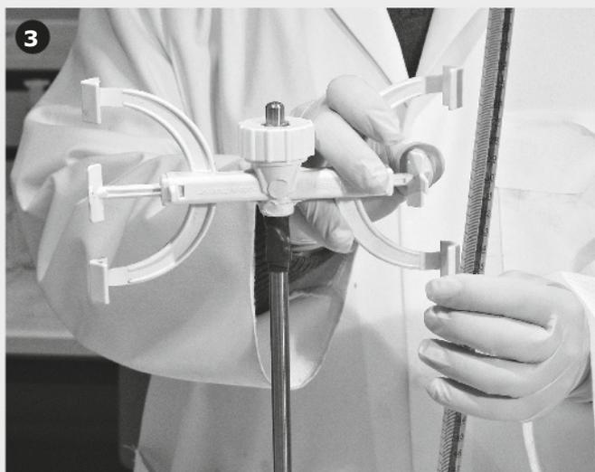
3 Riempi la buretta di soluzione standard di NaOH 0,1 mol/L evitando la formazione di bolle che potrebbero falsare la lettura del volume.
