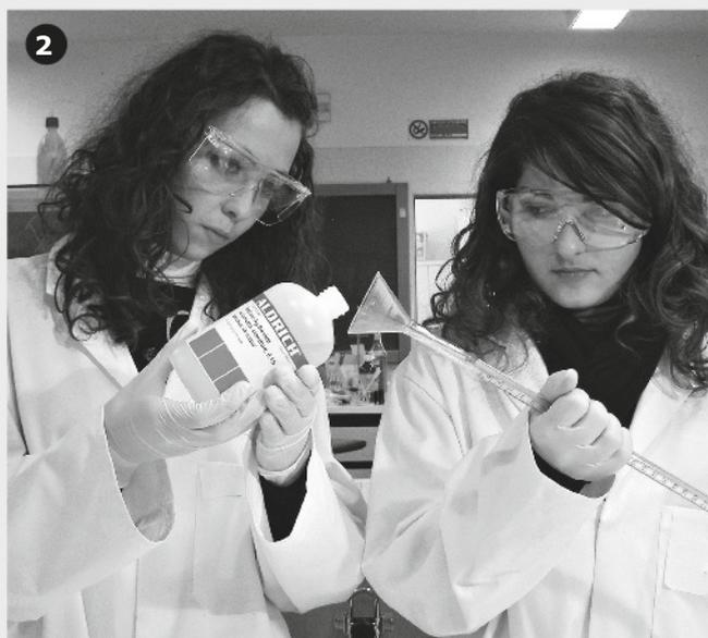
Avvina (cioè sciacqua internamente) la buretta due, tre volte utilizzando aliquote di circa 5-10 mL della soluzione standard di NaOH 0,1 mol/L.
