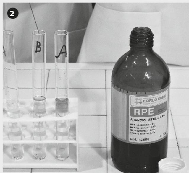
Con una pipetta Pasteur, aggiungi 2-3 gocce di metilarancio nella prima delle provette A, e altre 2-3 gocce nella prima delle provette B.
