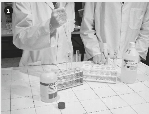
Con una pipetta Pasteur riempi di acido cloridrico diluito fino a circa metà altezza tre provette e con un pennarello contrassegna con la lettera A. Ripeti lo stesso procedimento utilizzando al posto dell'acido cloridrico l'idrossido di sodio diluito e contraddistingui questa volta le tre provette con la lettera B. Disponi in maniera alternata le sei provette nel porta-provette.
