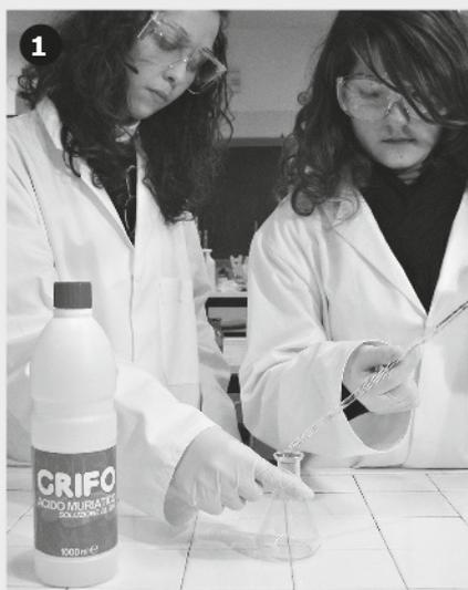
Versa nella beuta un volume esatto di acido muriatico (per esempio 2 mL) che hai prelevato con una pipetta munita di propipetta aspirante. Indica con  $V_{\text{HCl}}$  questo volume e riportalo nella tabella. Aggiungi acqua fino a raggiungere un volume finale di circa 20 mL.
