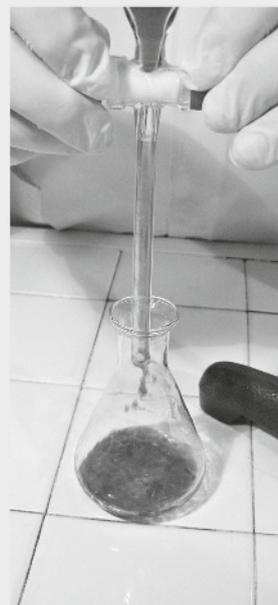
6 Riponi l'imbuto separatore nell'anello, rimuovi il tappo e lascia riposare fino a osservare la completa stratificazione dei due liquidi: la fase superiore si colorerà di viola intenso, mentre la fase inferiore assumerà una colorazione azzurra. Apri delicatamente il rubinetto e raccogli dentro una beuta la fase acquosa inferiore. Chiudi il rubinetto prima di iniziare a far fluire la fase organica che raccoglierai in un'altra beuta.
