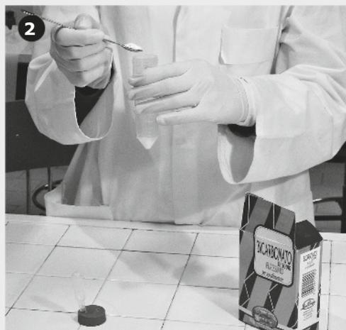
2 Introduci con una spatolina una piccola quantità di bicarbonato di sodio in una provetta di plastica munita di tappo al quale con un ferro caldo hai praticato due piccoli fori. In questo modo hai predisposto il recipiente dove far avvenire la reazione. Con una pipetta Pasteur riempi il gocciolatoio con l'acido muriatico e fissalo dalla parte del gambo a uno dei due fori del tappo.
