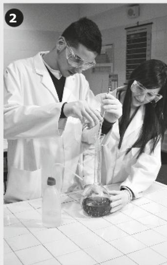
Sciogli ciascun soluto nello stesso becher dove è stato pesato con un po' d'acqua usando una spruzzetta e trasferisci la soluzione in un matraccio da 1 L munito di imbuto. Aggiungi tanta acqua fino a quando il livello del liquido raggiunge la tacca segnata nel collo del matraccio, tappalo e capovolgilo più volte per favorire la dissoluzione.
