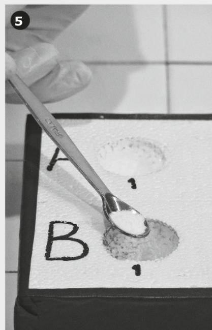
Versa una quantità di bicarbonato di sodio il più possibile uguale alla precedente nel primo pozzetto della fila B e annota in tabella il corrispondente valore  $t_f$  raggiunto.
