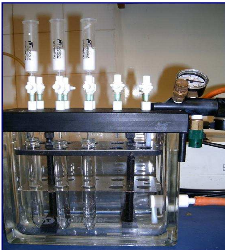
51. ábra: A fluoros Lawesson-reagens egyszerű eltávolítására szolgáló szűrőberendezés
