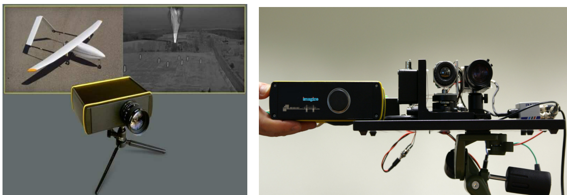
68–69. ábra: Pilóta nélküli repülő, erre tervezett vizuális felismerő és navigációs egység
