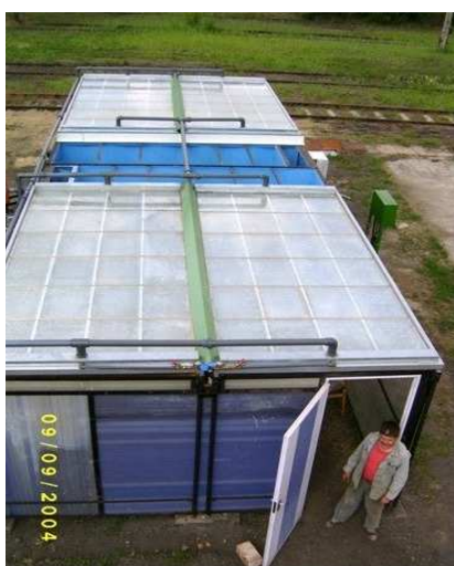
50. ábra: Napenergiát hasznosító víztisztító Hidas külterületén.
