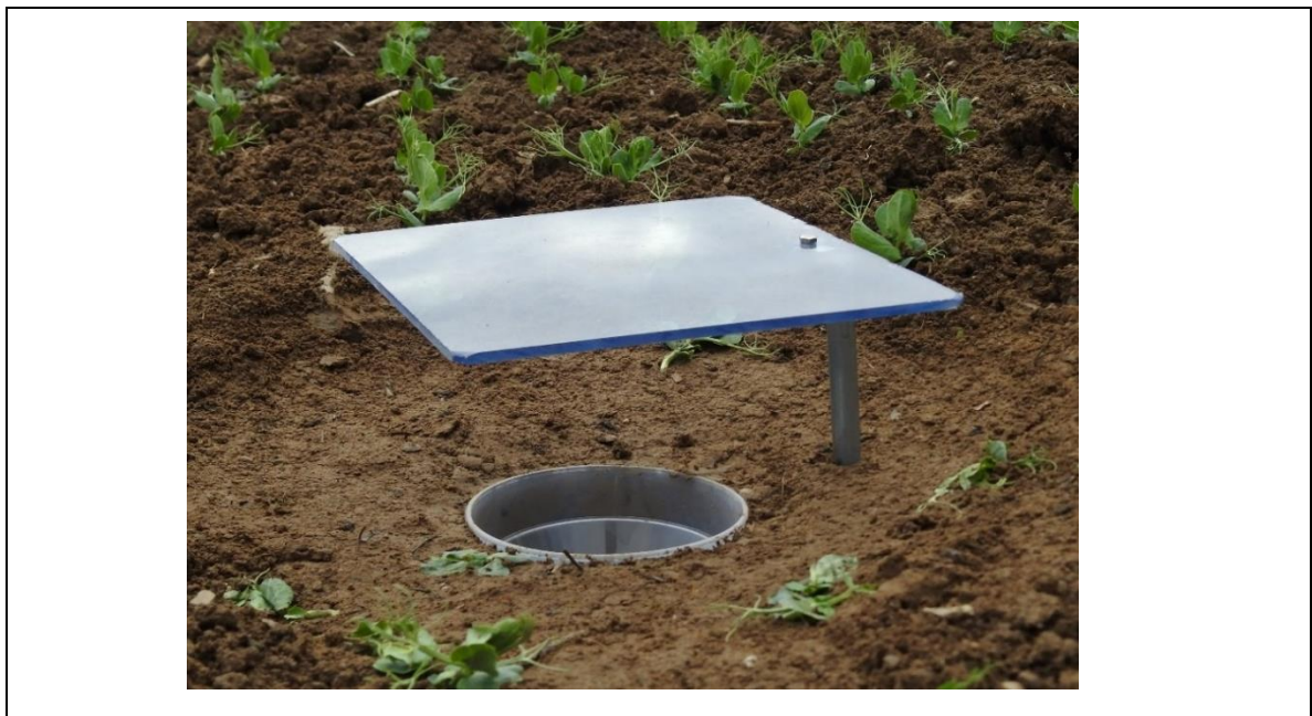
Abbildung 1: Barberfalle im Untersuchungsgebiet Ingweilerhof. Zu sehen ist das Fangbehältnis mit Glas und Trichter sowie die Plexiglasabdeckung zum Schutz vor Witterungseinflüssen
