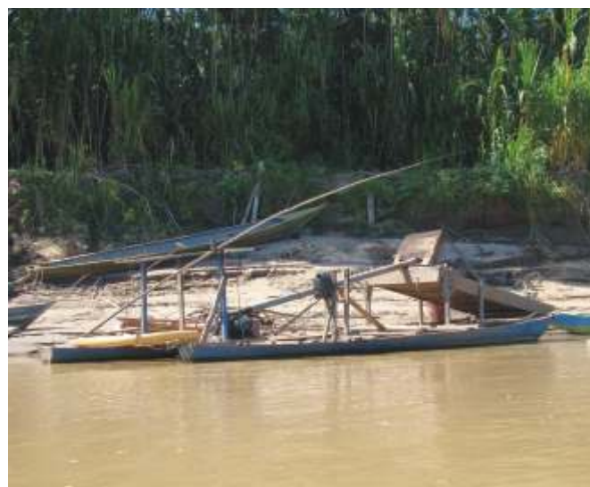
Figura 49. Implementos para la extracción de material del fondo del río.
