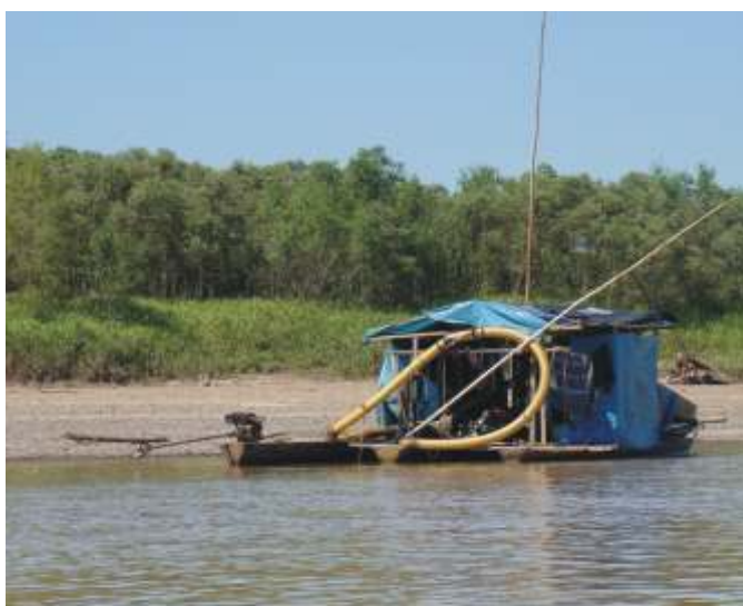
Figura 47. Extracción de material mediante succión.
