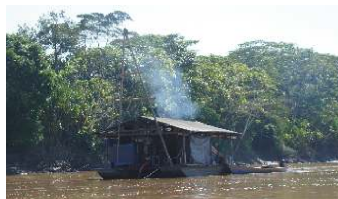
Figura 46. Barcaza que succiona material del fondo del río para la obtención de la arenilla aurífera.
