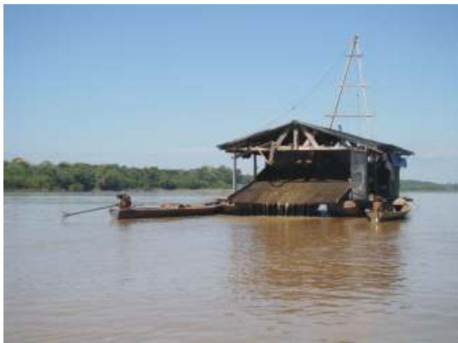
Figura 48. Extracción y separación de la arenilla que contiene el oro.
