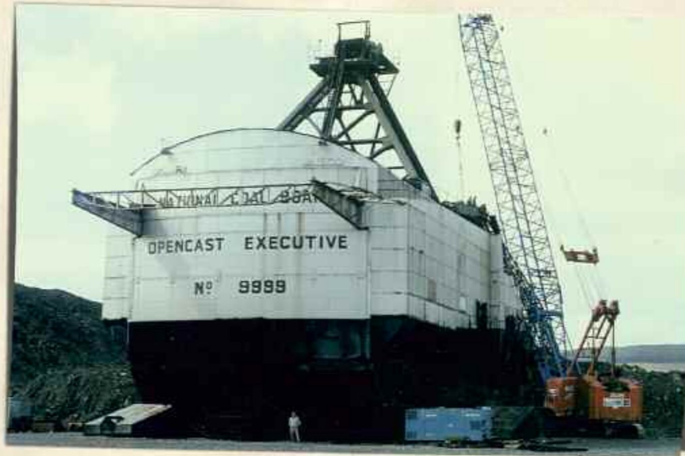
Datgymalu'r peiriant W1800 Ransome Rapier Walking Dragline ym Maesgwyn er mwyn ei gludo i UDA ym 1989. Adeiladwyd y peiriant hwn ar y safle a chafodd ei gomisiynu ym 1961. Dyma'r peiriant tir mwyaf yng ngwledydd Prydain ar y pryd, a gallai symud 10,000 tonn o ddeunyddiau mewn sifft 24 awr. Roedd yn pwysu 1,800 tonn ac yn cael ei alw'n 'Big Lady' ar lafar gwlad. George Brinley Evans sy'n sefyll oddi tano.
