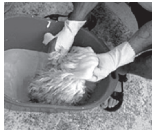
Fotografija 3. Proces izrade mijeha: namakanje kože u vapnu radi lakšeg guljenja vune; fotografija preuzeta s: www.centargerbin.org/pdf/MIH.pdf
