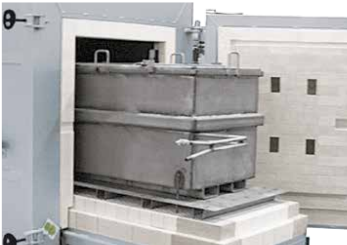
Schutzgaskasten für den Einsatz in einem Herdwagenofen
