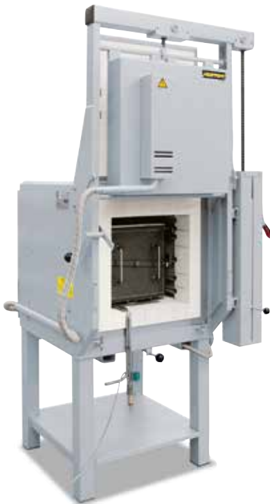
Kammerofen LH 60/12 mit Begasungskasten für Wärmebehandlungen unter Schutzgasatmosphäre
