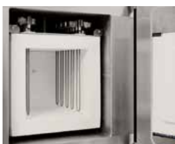
Molybdändisilid-Heizer mit Faserisolierung
