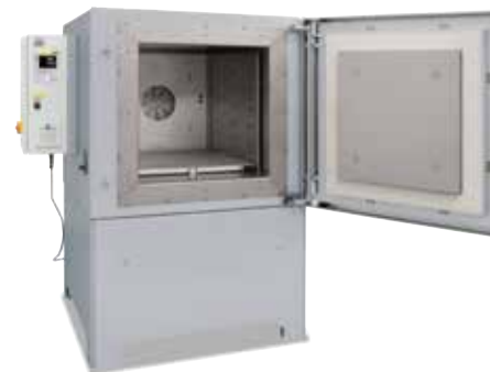
Umluft-Kammerofen NA 250/45 für Wärmebehandlungen an Luft
