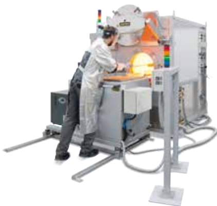
Halbautomatische Vergüteeinrichtung mit Retortenofen NR 50/11 und Wasserabschreckbad auf einem Schienensystem
