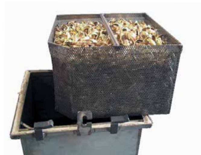
Blankglühen von Schüttgut in einem Glühkasten mit Evakuierungsmöglichkeit
