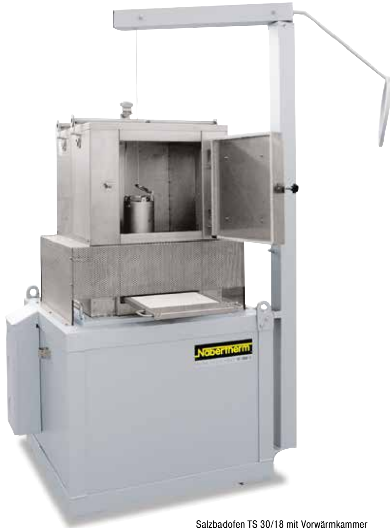
Salzbadöfen TS 30/18 mit Vorwärmkammer oberhalb des Salzbad und Beschickungshilfe zum Eintauchen der Charge
