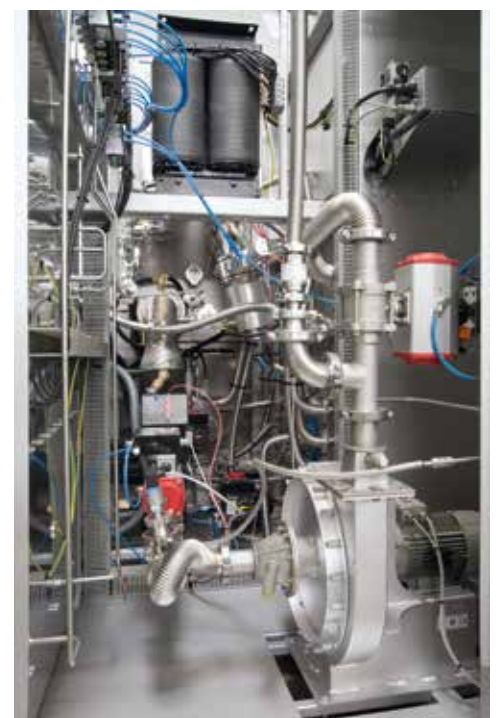
Gasschnellkühlung Kaltwand-Retortenofen VHT 8/16-MO
