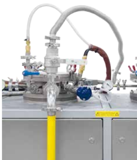
Wechselretorten mit Versorgungs- und Messleitungen
