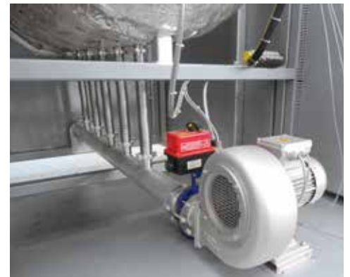
Gebläsekühlung Heißwand-Retortenofen NRA 400/03
