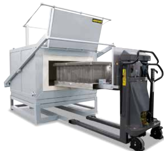
Chargierstapler WS 641 mit Kammerofen N 641 und Einfahrhilfe im Untergestell
