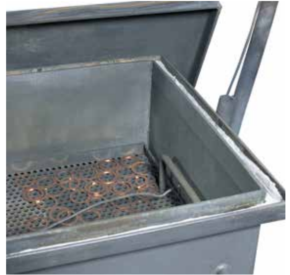
Wärmebehandlung im Begasungskasten unter Schutzgasatmosphäre mit Chargethermoelement
