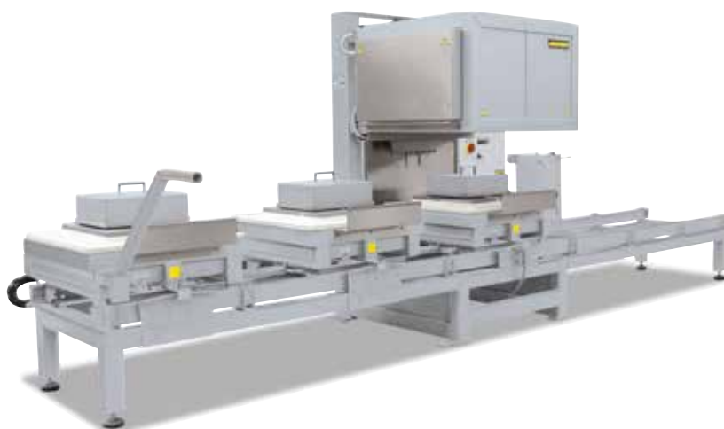
Haubenofenanlage mit drei Wechseltischen und Begasungskästen für die Wärmebehandlung unter nicht brennbaren Schutz- oder Reaktionsgasen
