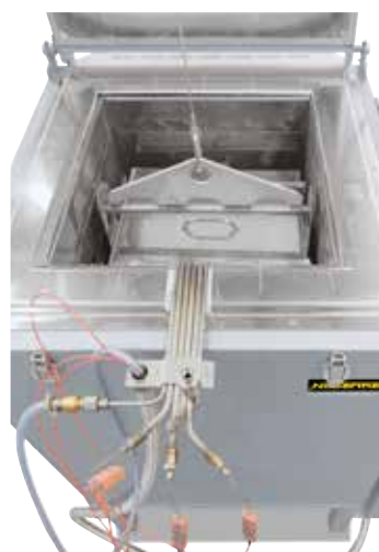
Begasungskasten, Ausführung für AMS 2750 E
