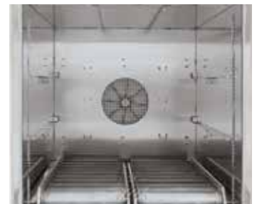
Rollengang im Umluft-Kammerofen N 250/85HA
