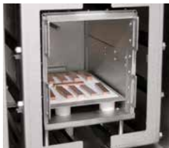
Wärmebehandlung von Kupferstäben unter Wasserstoff im Retortenofen VHT 8/16-MO
