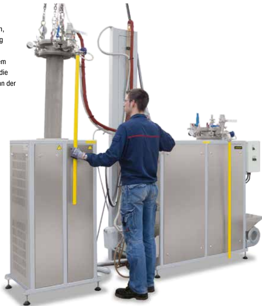
Retortenofen SR 170/1000/11 mit Wechselretorte und Kühlstation
