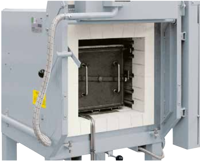
Fest eingebauter Begasungskasten mit Chargierung von vorn
