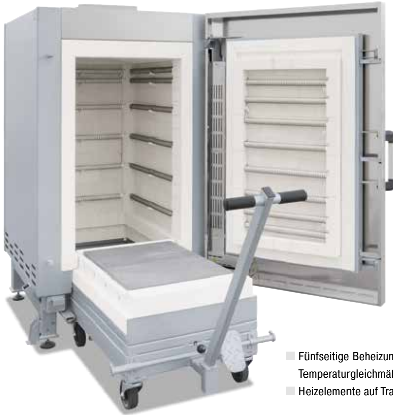
Kammerofen NW 440 mit frei verfahrbarem Wagen
