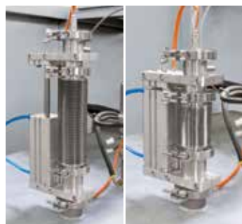
Thermoelement, Typ S mit automatischer Herausziehvorrichtung für sehr gute Regelergebnisse im unteren Temperaturbereich
