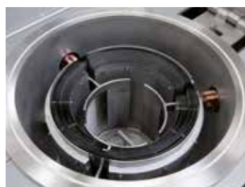
Zylindrische Retorte mit Wolframbeheizung
