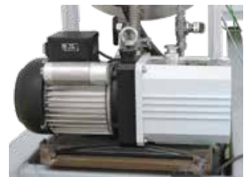
Vakuumpumpe zum Kaltevakuieren der Retorte
