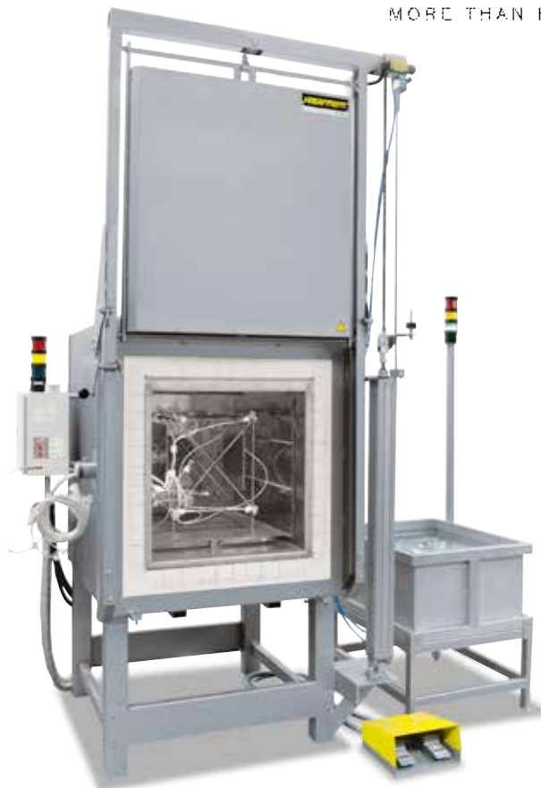
Umluft-Kammerofen N 250/85HA mit Abschreckbad
