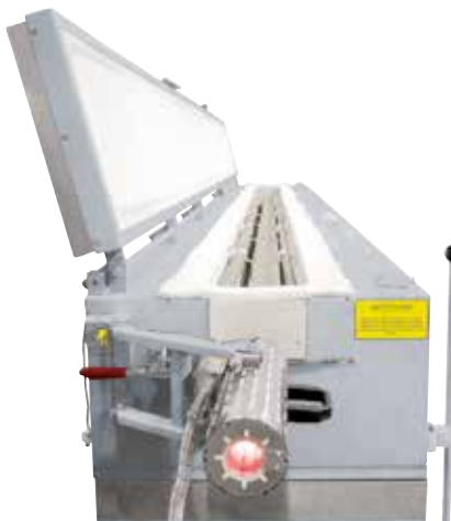
Drahtdurchziehofen auf Basis eines Rohr- ofens mit einer Länge von 6 Metern
