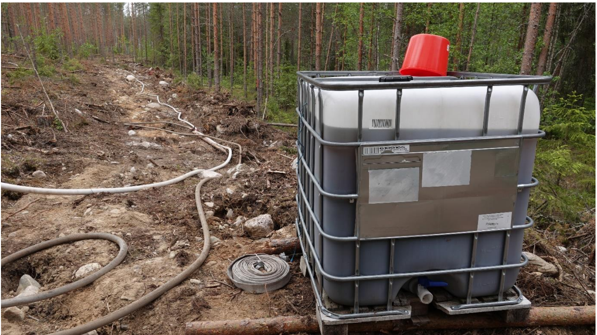
Paveikslas Nr. 6. Greta tvarkomo ugnimi ploto buvo keletas vandens talpų. Vandens tiekimas žarnomis iš mobilaus vandens siurblio buvo organizuotas visu tvarkomo ploto perimetru, kas 20-40 m. prie magistralinės šlangos prijungiant laistymo elementus.
